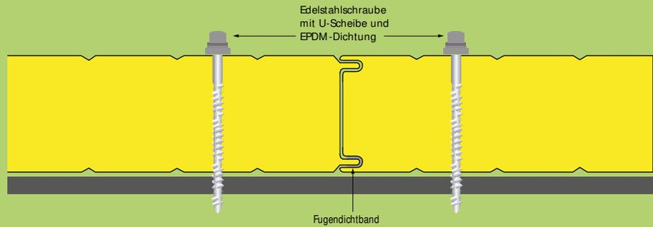
Das Sandwichelement mit einem mineralischen Dämmkern aus Glaswolle und Stahldeckschalen erfüllt die Anforderungen eines nichtbrennbaren Baustoffes. Die speziell für die Verarbeitung in einer kontinuierlichen Produktionslinie entwickelte Glaswolle besteht zu 80% aus Recyclingmaterial und spart natürliche Ressourcen ein. Durch die Optimierung der Rohdichte des Dämmkerns hat die Metfiber® Eco Wand gegenüber den üblichen
