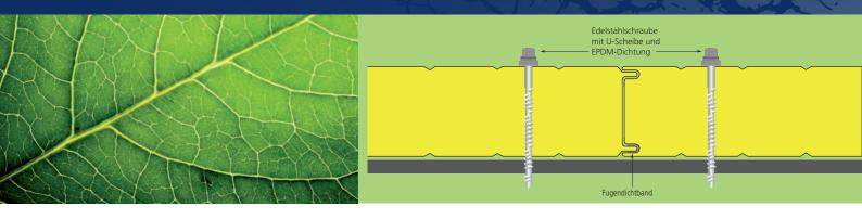
Das Sandwichelement mit einem mineralischen Dämmkern aus Glaswolle und Stahldeckschalen erfüllt die nichtbrennbaren Anforderungen eines Baustoffes. Die speziell für die Verarbeitung in einer kontinuierlichen Produktionslinie entwickelte Glaswolle besteht zu 80 % aus Recyclingmaterial und spart natürliche Ressourcen ein. Durch die Optimierung der Rohdichte des Dämmkerns hat die Metfiber® Eco Wand gegenüber den üblichen
