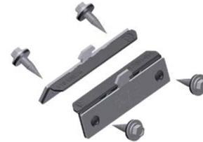
Schletter „SingleFix-V“ aus Edelstahl 1.4301 ist eine sichere Befestigungsmöglichkeit mit optimiertem Materialeinsatz für eine vertikale Modulmontage. Zusammen mit der Modulschiene Solo05 und zwei SingleFix-V Laschen mit untergelegtem EPDM-Dichtung (Zubehör) entsteht eine stabile, kompakte Verbindung für die Aufnahme der Solarmodule. Die Befestigung erfolgt an den Seitenstegen der Elementhochsicke mittels 2 Stück zugelassener Bohrschrauben mit Unterlagsscheibe und EPDM-Dichtung.
