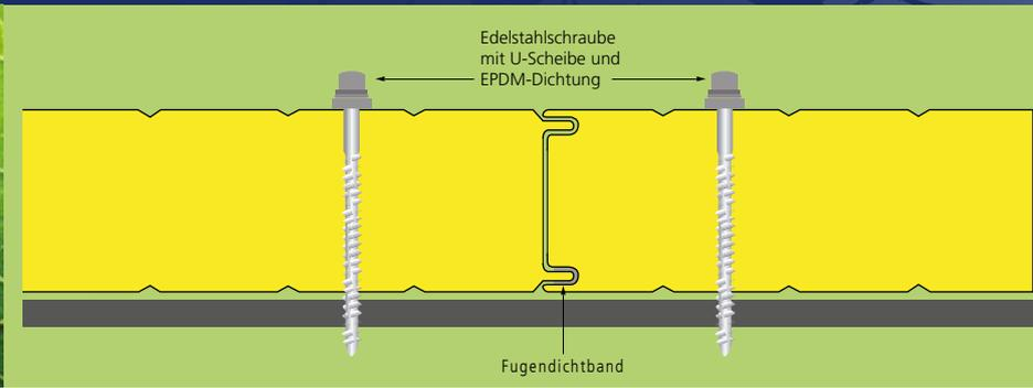
Das Sandwichelement mit einem mineralischen Dämmkern aus Glaswolle und Stahldeckschalen erfüllt die Anforderungen eines nichtbrennbaren Baustoffes. Die speziell für die Verarbeitung in einer kontinuierlichen Produktionslinie entwickelte Glaswolle besteht zu 80 % aus Recyclingmaterial und spart natürliche Ressourcen ein. Durch die Optimierung der Rohdichte des Dämmkerns hat die Metfiber® Eco Wand gegenüber den üblichen
